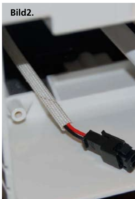
Bild 2. Ifall det bakom apparatens innerenhet finns en koppling, som på bilden, skall den ej anslutas någonstans.
